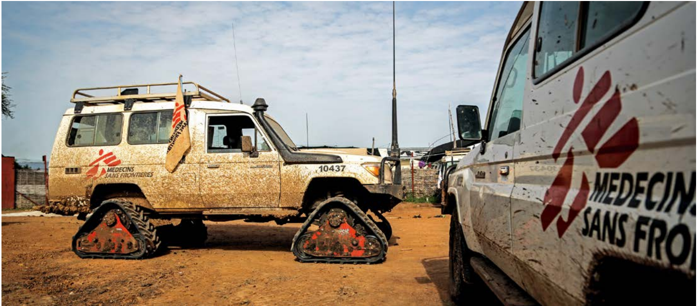
Au Soudan du Sud, les chenilles ont remplacé les roues des ambulances et des voitures, car les routes devenaient impraticables au moment de la saison des pluies. ©Pierre-Yves Bernard/MSF
