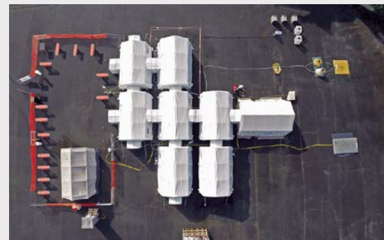
Diese rasch montierbare Chirurgieeinheit kann zeitnah in Katastrophengebiete transportiert werden. Sie ist innerhalb von zwei Tagen einsatzbereit und funktioniert völlig autonom. ©Beatriz Sierra Cuerva/MSF
